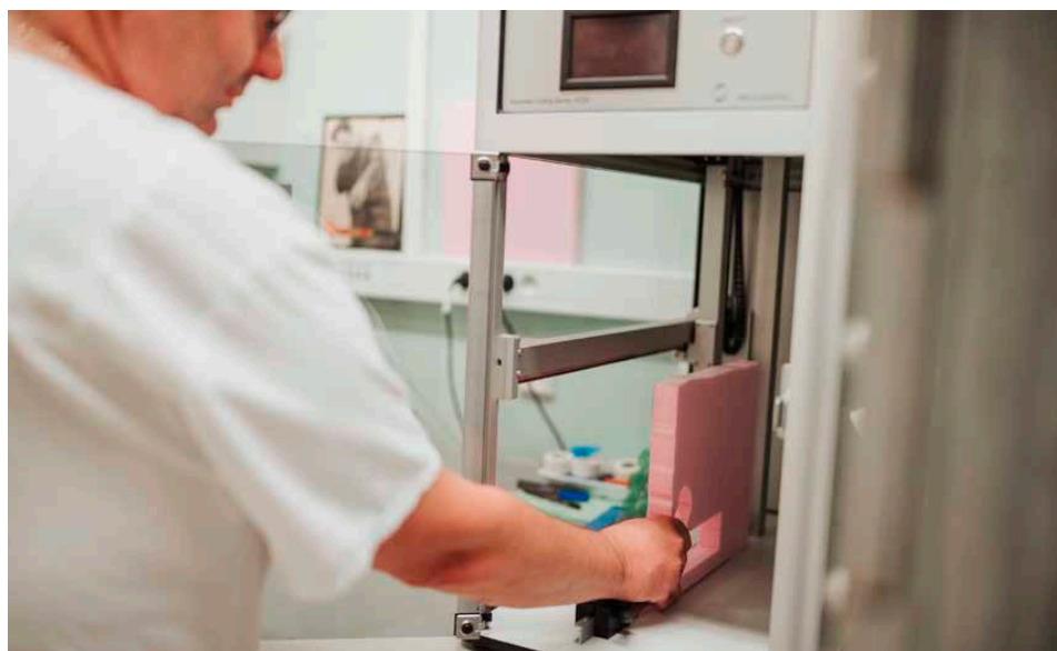
Automatická vyřezávačka polystyrenu pro výrobu stínících bloků
