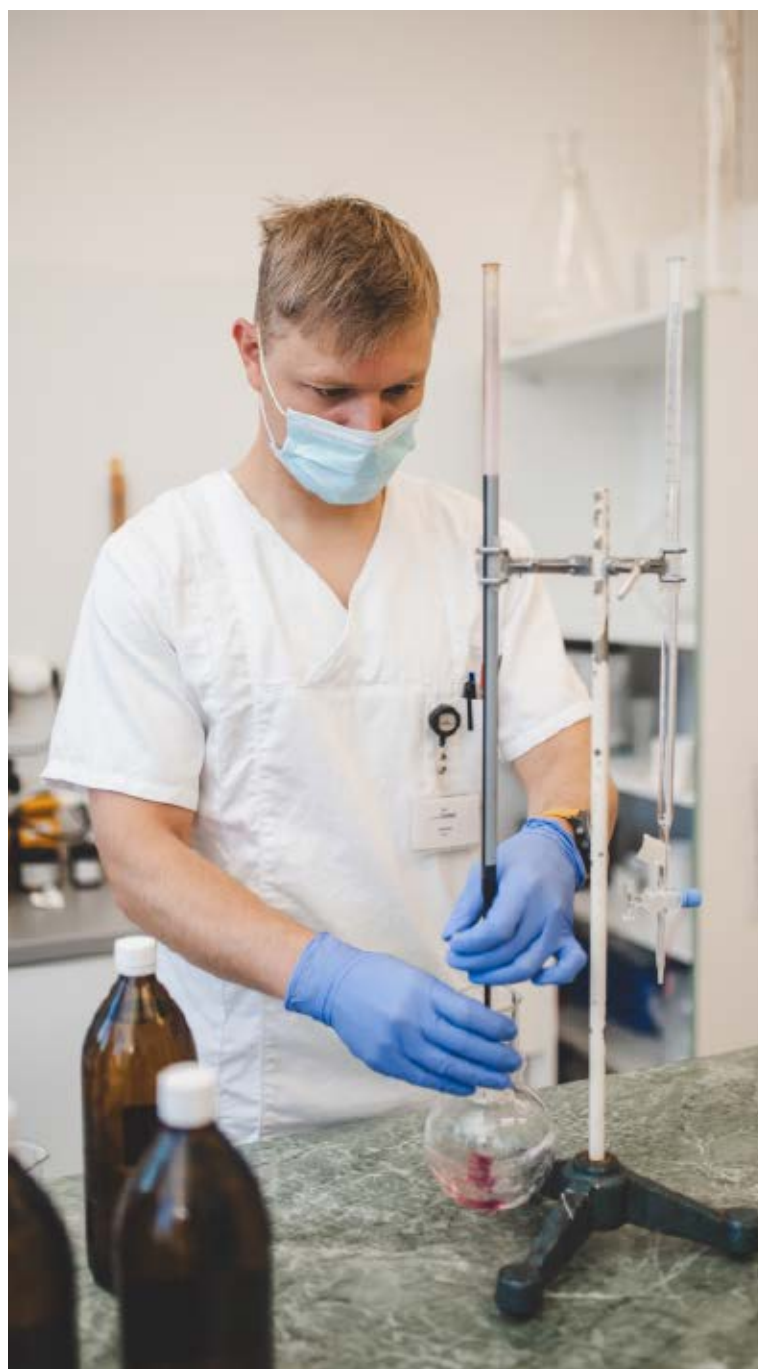
Mgr. Ondřej Černý při práci v analytické laboratoři – provádí titraci k určení koncentrace účinné látky | Foto: Jan Luxík
