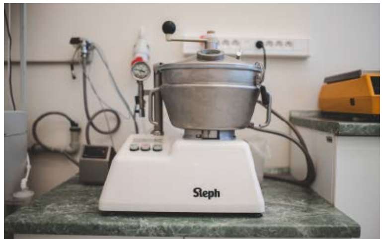
Velkoobjemová příprava polotuhých léčivých forem – mastí a krémů – probíhá s využitím homogenizátorového systému Stephan | Foto: Jan Luxík
