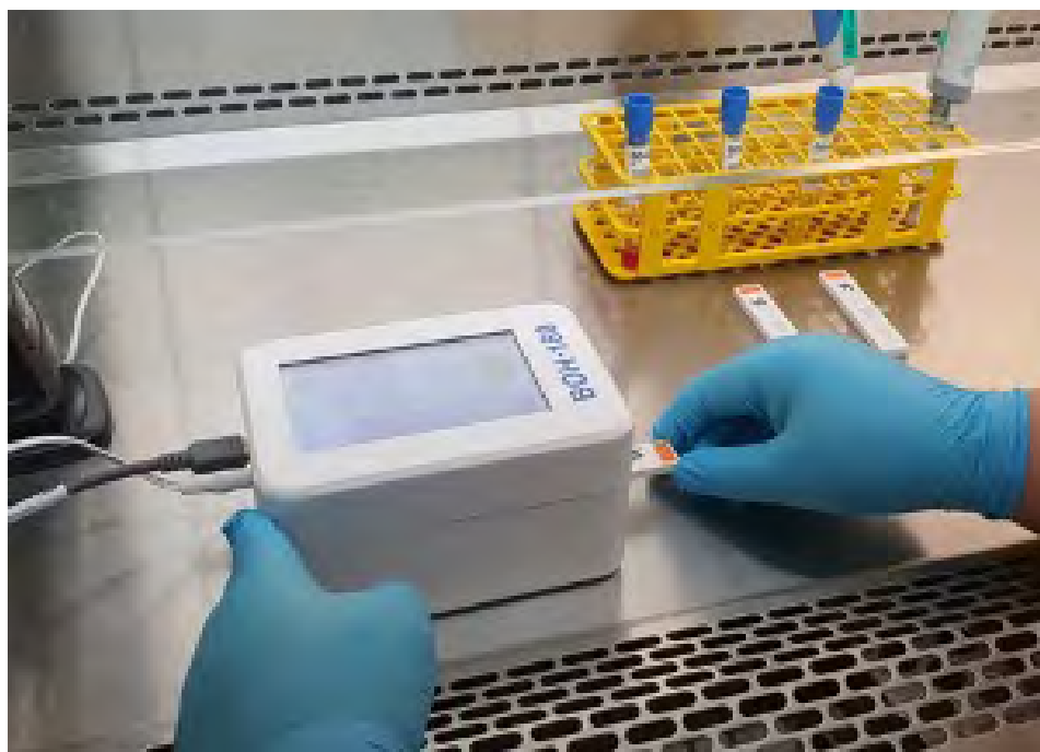
Kvantitativní stanovení N-antigenu SARS-COV-2 z krve. Měření výsledné hodnoty na testovacím proužku přístrojem / Foto: archiv laboratoře
