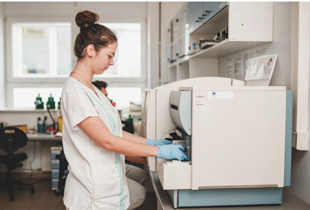
Laborantka Bc. Barbora Petřiková vkládá karty se suspenzemi bakteriálních kmenů pro stanovení MIC do přístroje VITEK 2 / Foto: Jan Luxík
