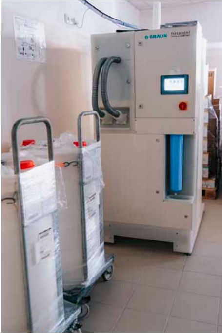
Automatizovaný systém ECOMIX Revolutin pro míchání a distribuci kyselých koncentrátů / Foto: redakce
