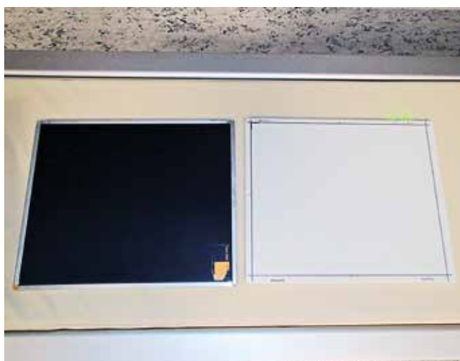
Detektor Philips Diagnost ve srovnání s konvenční kazetou pro nepřímou digitalizaci
