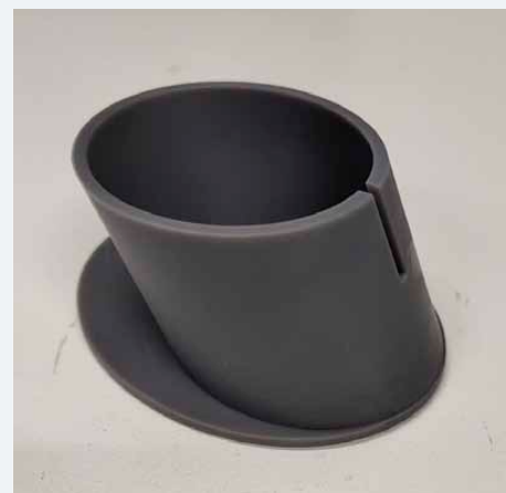
Stojan na stíněnou nádobku s radioaktivní látkou
