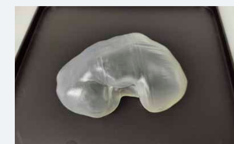
Hotový výtisk po odstranění podpěr
