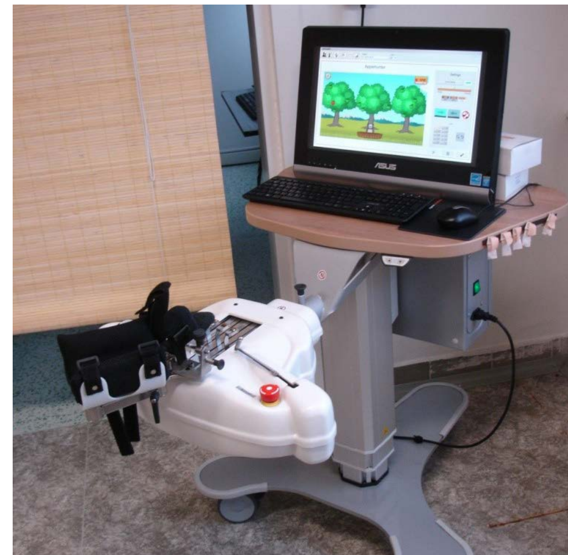
Obrázek č. 2 - robotický systém pro funkční terapie horní končetiny s motivační Zpětnou vazbou pro cvičení ruky a jednotlivých prstů (AMADEO) | Foto: autorka
