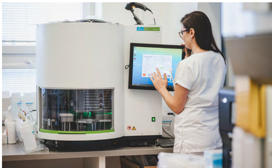
Automatická izolace nukleových kyselin / Foto: Jan Luxík
