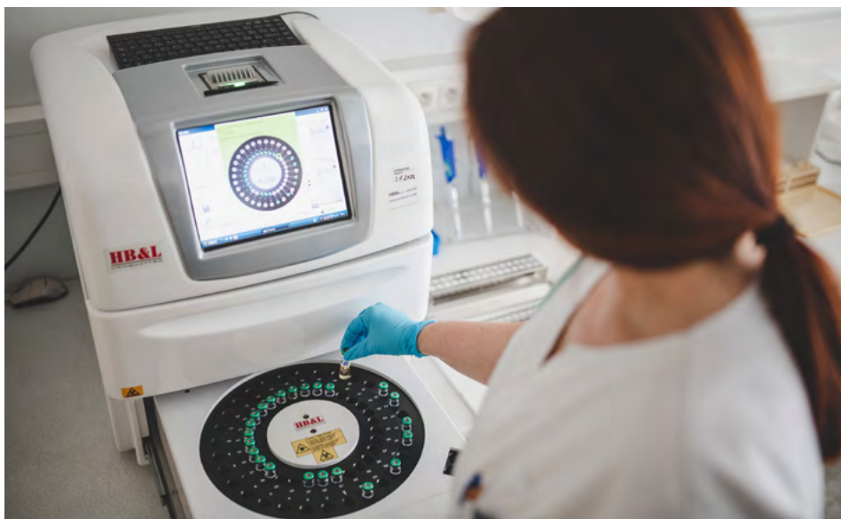
Vkládání lahvíček se vzorky moče do analyzátoru Uroquatro ke stanovení kvantitativní bakteriurie / Foto: archiv laboratoře
