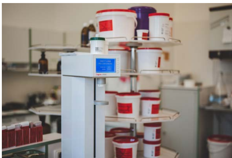
Moderní systém SAMIX pro automatizovanou homogenizaci polotuhých lékových forem – mastí a krémů | Foto: Jan Luxík
