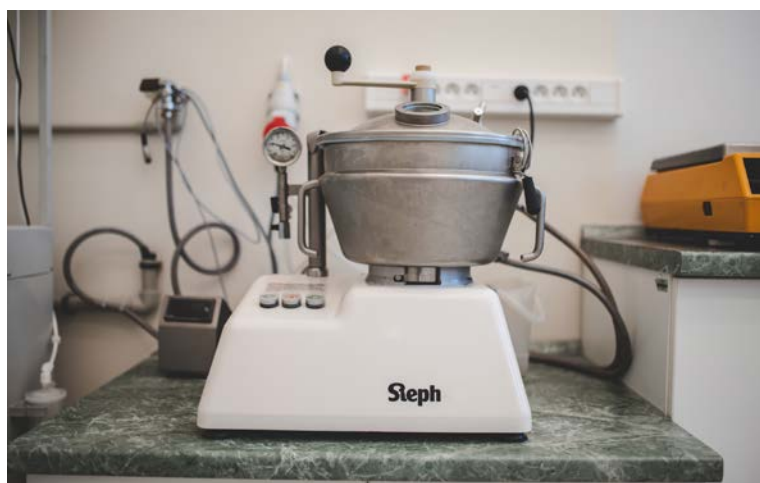
Velkoobjemová příprava polotuhých lékových forem – mastí a krémů – probíhá s využitím homogenizátorového systému Stephan | Foto: Jan Luxík
