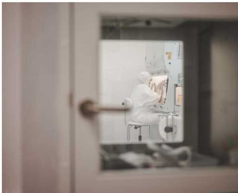
Cytostatika v podtlakových izolátorech v čistých prostorech připravuje farmaceutická asistentka Romana Koudelková. Čisté prostory přípravný jsou od ostatního prostředí odděleny systémem materiálových a personálních propustí | Foto: Jan Luxík
