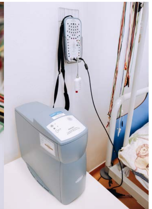
Vlevo: Na tělo pacienta se přikládá celkem 25 elektrod a senzorů, které se připevňují speciálním lepidlem nebo lepicí páskou. Tyto komponenty jsou následně zapojeny do Overhead panelu (fotografie vpravo - nahoře), který spojuje veškerou periférii se samotným přístrojem – polysomnograf. / Foto: redakce
